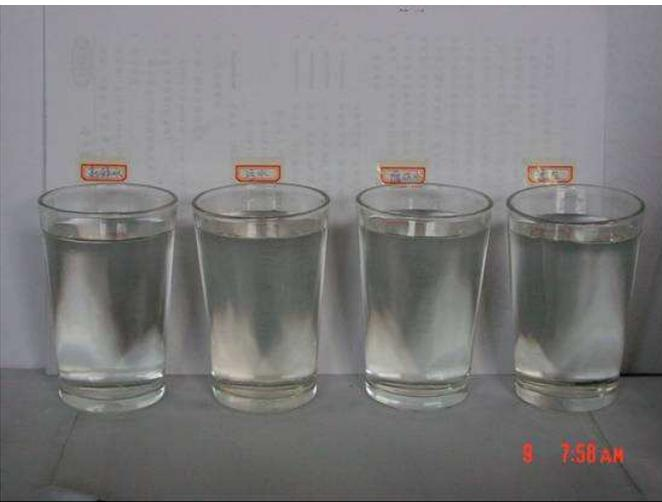
6、石家庄第二循环水场高级氧化设备使用场所的四种水样：新鲜水、污水、循环水、旁滤池滤后水。其中污水有异味，新鲜水、循环水、旁滤池滤后水均无任何异味。
