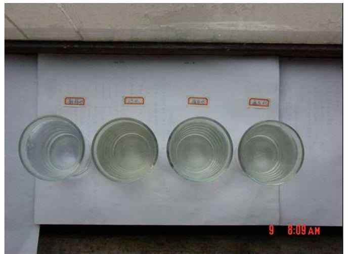
7、石家庄第二循环水场高级氧化设备使用场所的四种水样：新鲜水、污水、循环水、旁滤池滤后水。其中污水略混有异味，新鲜水、循环水、旁滤池滤后水均无任何异味。
