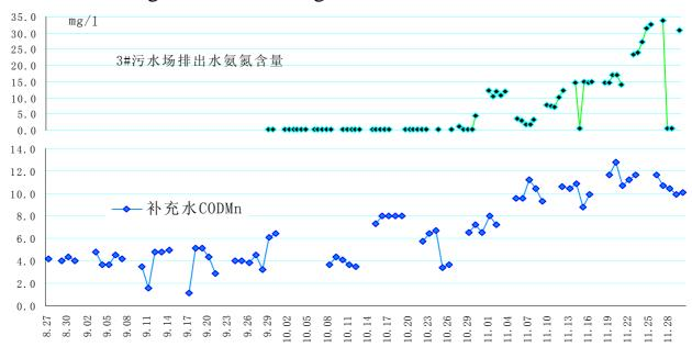
我们部分采用了该技术对持续泄漏的 3<sup>#</sup>循环水场进行处理,效果显著。在泄漏背景下多年未见的余氯可检出,大量沉积的污泥被清除,长期超标的浊度等水质指标达标了,系统由恶性循环状态终于转入良性运行。几十天的处理期间一直按系统的最高浓缩倍数运行,系统不排污、不溢流、不置换,低水耗、低药耗,直将系统状况逆转。浊度曲线如下:
