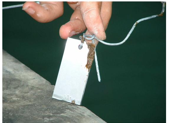
8月13日，死水区，油块排出挂在试片上，污油下未有可见腐蚀发生。
