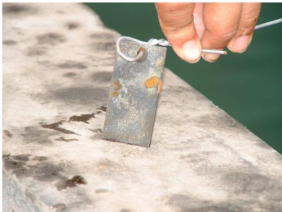
8月13日，死水区的旧片，上面有被固化的锈瘤脱落的痕迹，还有碰撞后形成新的锈瘤，无明显坑蚀。
