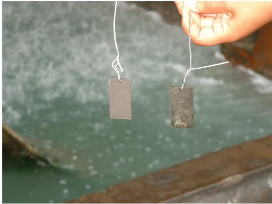
8月13日，塔池中同一地点放入的新试片和旧试片，旧试片的腐蚀层已固化，未再发生垢下腐蚀。
