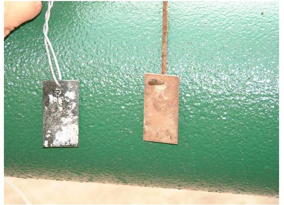
8月13日，冷水池的旧试片和旧试片放入前的情形。旧试片的腐蚀层已固化，未未见明显垢下腐蚀。
